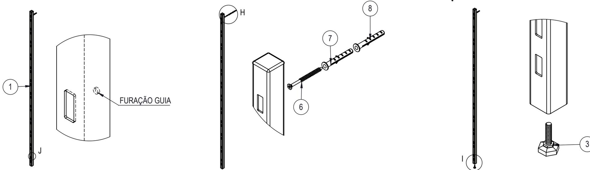
**1** MARCAR PONTOS DE FIXAÇÃO NO LOCAL ONDE SERÁ INSTALADO A COLUNA (1). UTILIZAR AS FURAÇÕES DO PRODUTO COMO GABARITO.
