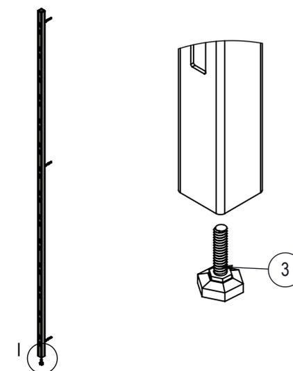
**1** MARCAR PONTOS DE FIXAÇÃO NO LOCAL ONDE SERÁ INSTALADO A COLUNA (1). UTILIZAR AS FURAÇÕES DO PRODUTO COMO GABARITO.
