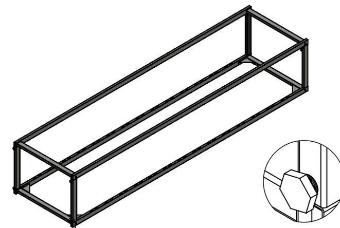
**1** COM O EQUIPAMENTO DEITADO NO CHÃO, ENCAIXAR OS TUBOS DE LIGAÇÃO (3 E 4), NOS RECORTES DA LATERAL (1).
