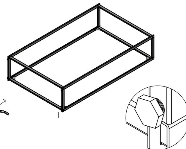
**1** COM O EQUIPAMENTO DEITADO NO CHÃO, ENCAIXAR OS TUBOS DE LIGAÇÃO (3 E 4), NOS RECORTES DA LATERAL (1).
