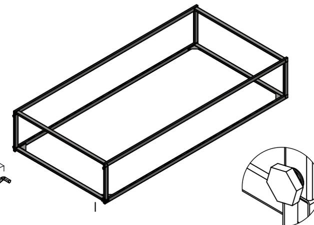
**1** COM O EQUIPAMENTO DEITADO NO CHÃO, ENCAIXAR OS TUBOS DE LIGAÇÃO (3 E 4), NOS RECORTES DA LATERAL (1).
