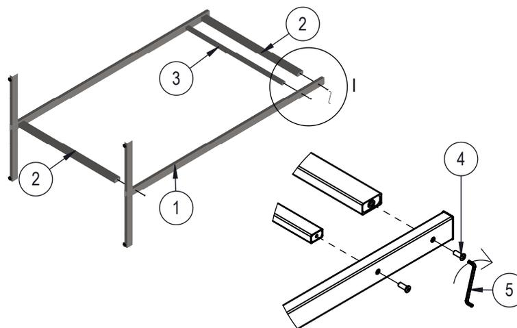
**2** ENCAIXAR A OUTRA LATERAL (1) NOS TUBOS DE LIGAÇÃO (2 E 3), REPETINDO O PASSO ANTERIOR. ROSQUEAR COM A CHAVE ALLEN (5) OS TRÊS PARAFUSOS (4) ATÉ A METADE.
