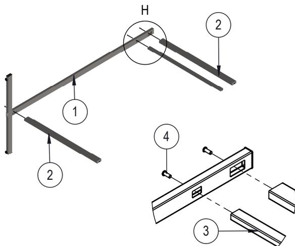
**1** POSICIONAR A LATERAL (1) NO PISO, CONFORME FIGURA ACIMA. ENCAIXAR OS TUBOS DE LIGAÇÃO (2 E 3) NOS RECORTES DA LATERAL. ROSQUEAR OS PARAFUSOS (4) ATÉ A METADE.
