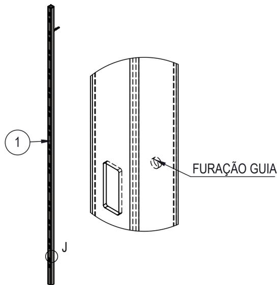
**1** MARCAR PONTOS DE FIXAÇÃO NO LOCAL ONDE SERÁ INSTALADO A COLUNA (1). UTILIZAR AS FURAÇÕES DO PRODUTO COMO GABARITO.
