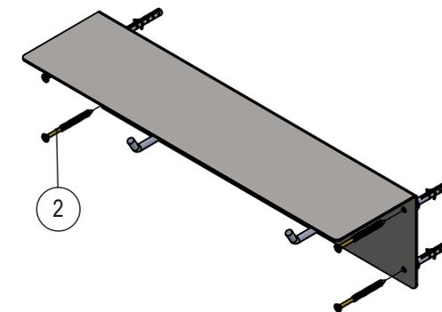
**1** MARCAR PONTOS DE FIXAÇÃO NO LOCAL ONDE SERÁ INSTALADO A PEÇA (1). UTILIZAR AS FURAÇÕES DO PRODUTO COMO GABARITO. LEMBRE-SE QUE DEVE HAVER REFORÇO NA PAREDE.
